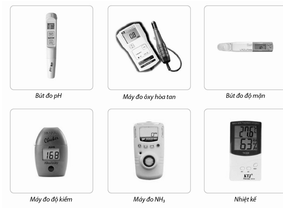
Hình 25. Một số dụng cụ đo kiểm môi trường
